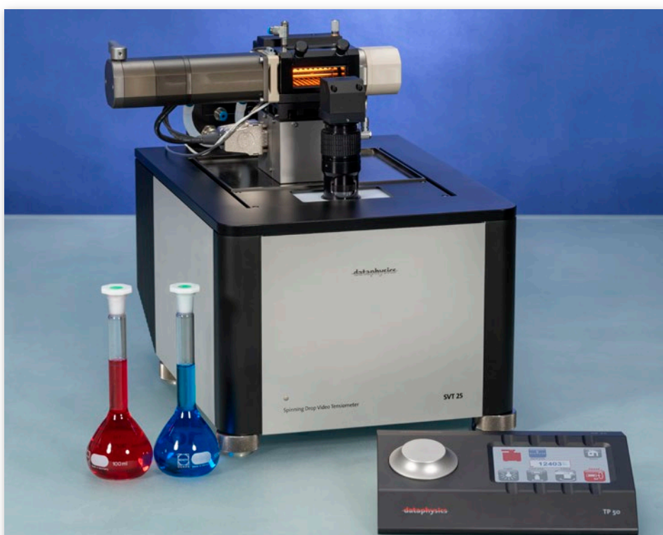
SVT 25 avec cellule de mesure à température contrôlée MC-TPC 25 et panneau de commande TP 50
