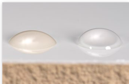
Los ángulos de contacto medidos con dos líquidos de ensayo son la base para calcular la energía superficial del sólido.
