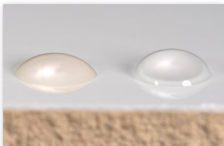
Die Kontaktwinkel zweier Testflüssigkeiten dienen als Berechnungsgrundlage für die Oberflächenenergie.
