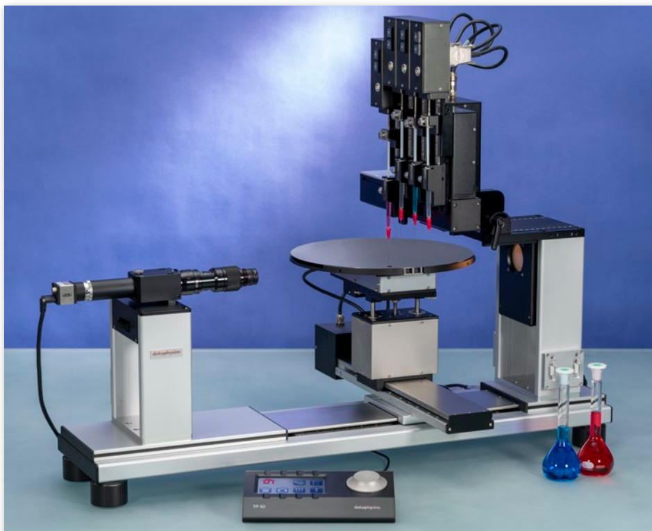
« Cartographie » de l'énergie de surface sur wafer de 12 pouces à l'aide d'un OCA 50L, d'un portique électronique DDE/4, de quatre pousse-seringues électroniques ESr et d'un plateau tournant électronique à fixation sous vide ETTr/VAC.
