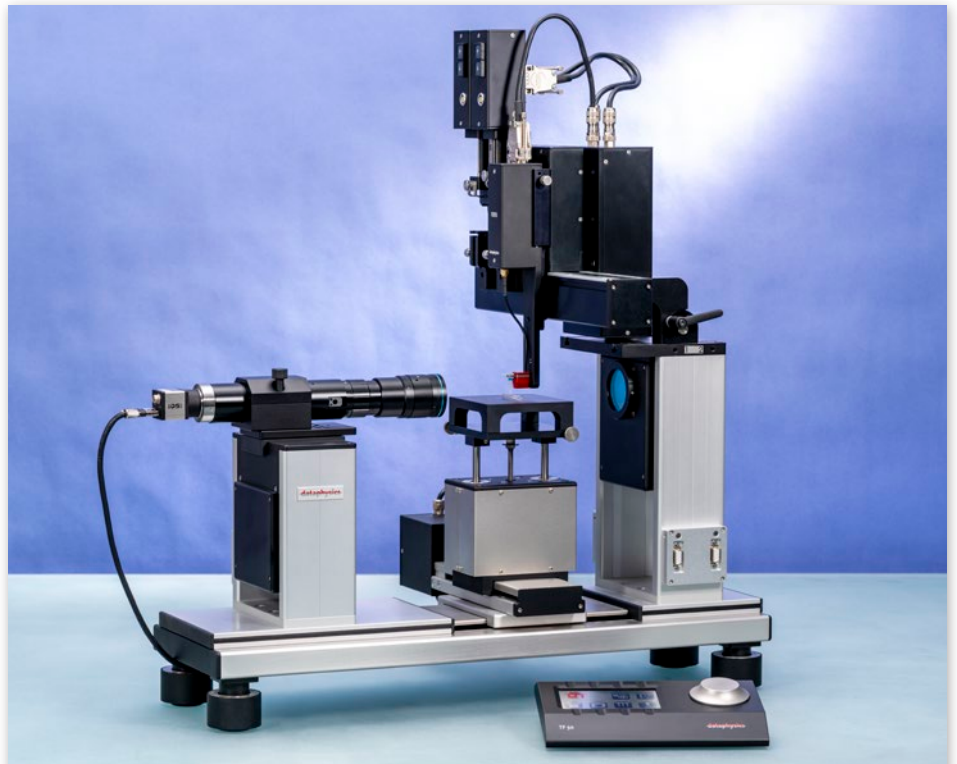
Mesures de l'angle de contact sur des échantillons microstructurés à l'aide d'un OCA 200 équipé du système de dosage FDDS FlexDrop
