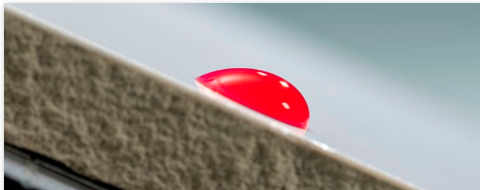
Détermination des angles de contact d'avancée et de recul par mesure dynamique de l'angle de contact sur un carreau à l'aide d'une unité de base inclinable électronique TBU 100.
