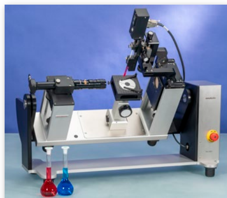
Base basculante electrónica TBU 100EC para medir el ángulo de contacto dinámico
