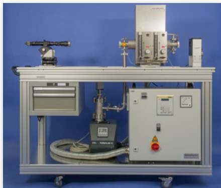
OCA 25-HTV 1800 para mediciones del ángulo de contacto en un horno de alta temperatura
