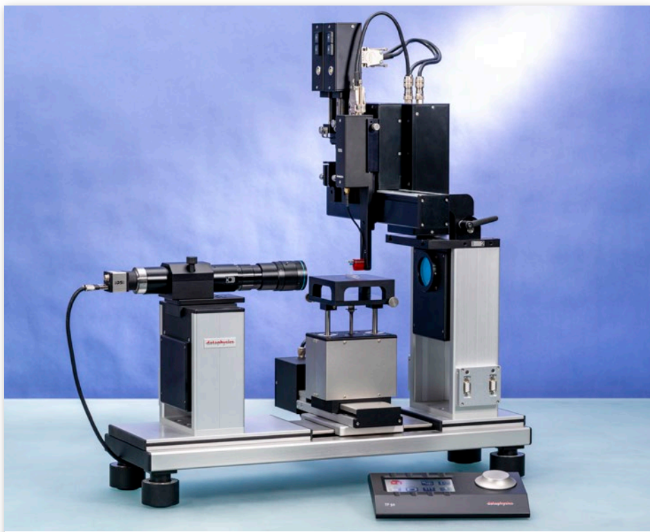
Mediciones del ángulo de contacto en muestras microestructuradas utilizando un OCA 200 con el sistema de dosificación FDDS FlexDrop
