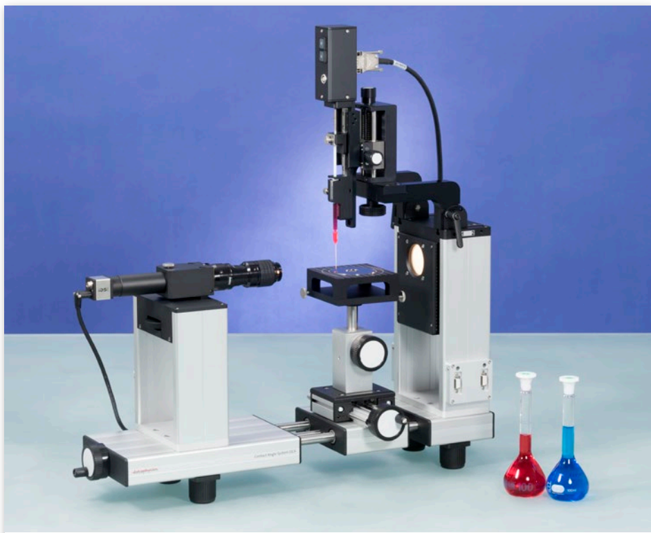
Medición del ángulo de contacto con un OCA 25 equipado con un sistema de dosificación directa simple SD-DM y un módulo de jeringa electrónico ESr
