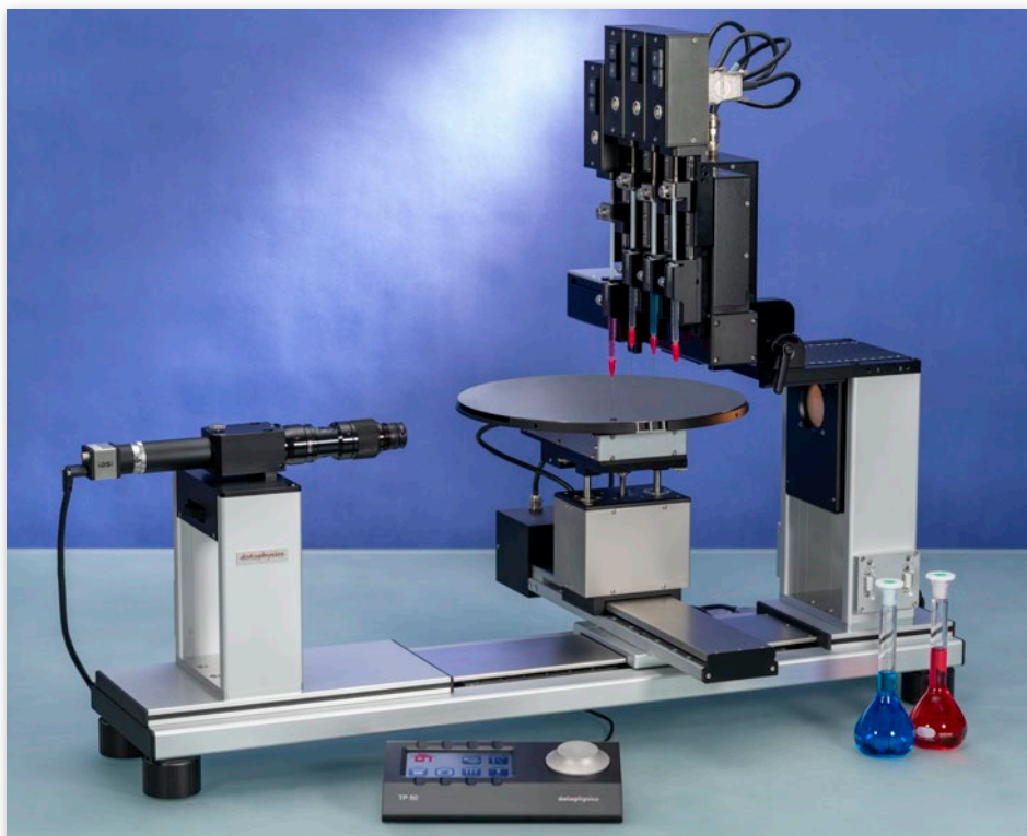
«Mapeo» de energía superficial de una oblea de 12" con OCA 50L, dosificación directa electrónica DDE/4, cuatro módulos de jeringa electrónicos ESr y plataforma giratoria electrónica ETTr/VAC
