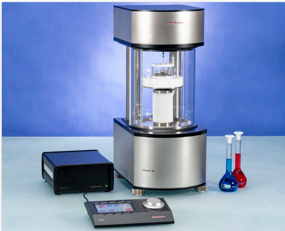
DCAT 25 avec unité de régulation de température Peltier TV 50-P, régulateur de température TC-U et panneau de commande TP 50
