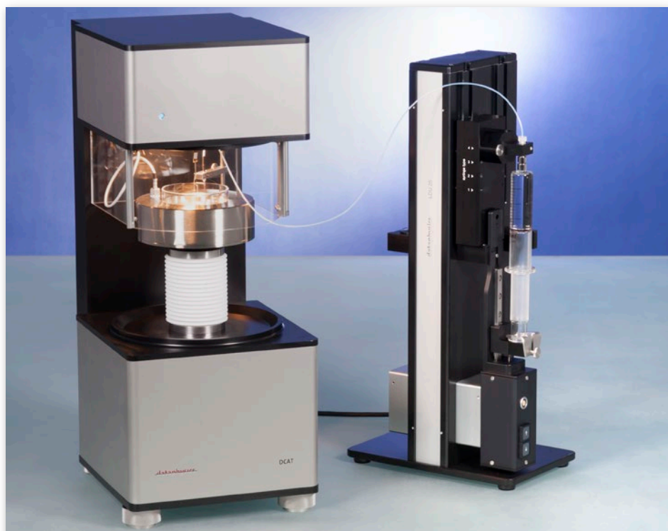
Détermination de la concentration micellaire critique à l'aide d'un DCAT 15 et d'un LDU 25 équipés d'un porte-seringue SH-LDU
