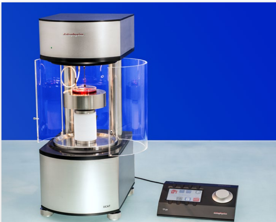
Bestimmung der Kontaktwinkelhysterese an einer Faser in einem DCAT 25SF mit TP 50 Steuergerät
