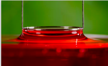
Du Noüy-Ring mit Flüssigkeitslamelle
