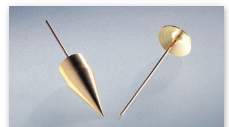
Penetrationsprüfkörper PP 11 und Sedimentationskegel SC 11
