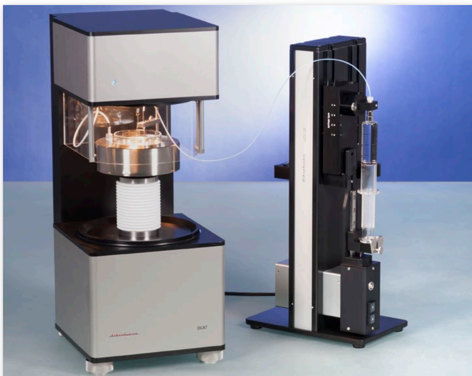
Bestimmung der kritischen Mizellbildungskonzentration mit DCAT 15 und LDU 25 mit Spritzenhalter SH-LDU
