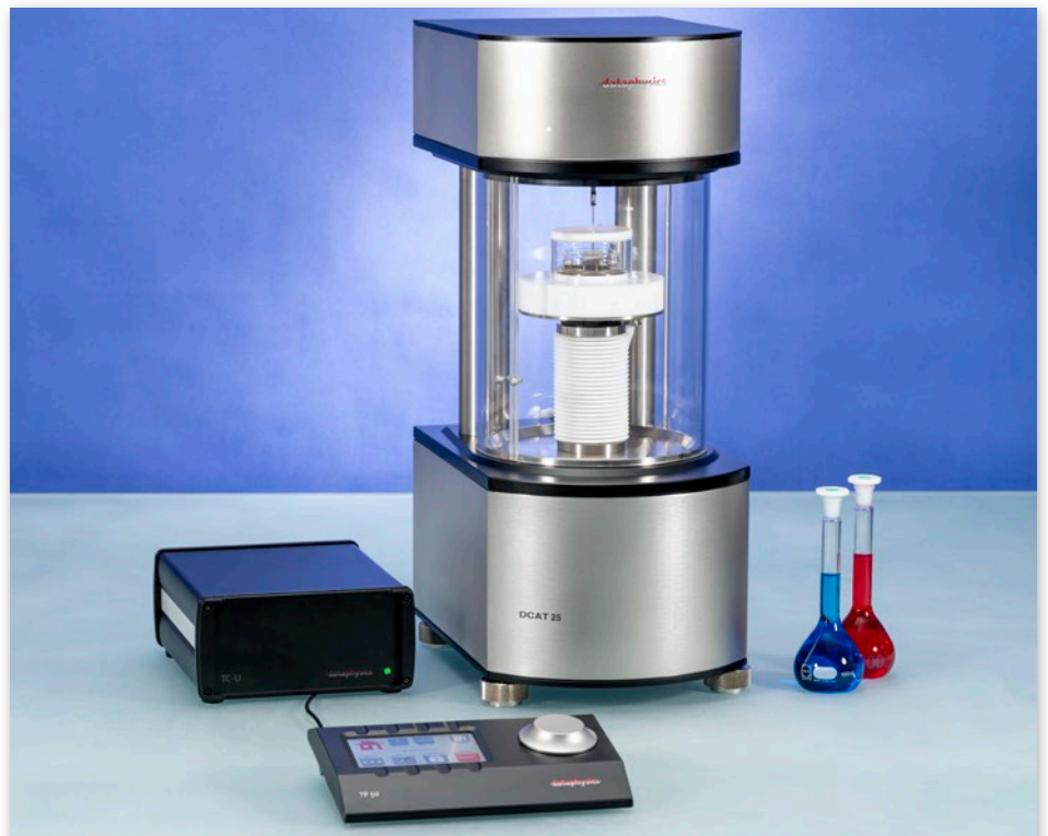
DCAT 25 mit Peltier-Thermostatisiereinrichtung TV 50-P, Temperaturregler TC-U und TP 50 Steuergerät
