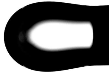
Abb. 2 Hängender Tropfen eines Heißklebers bei 120^\circ\text{C} .
