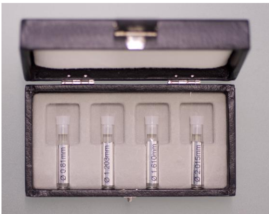
Bild 1: Referenz-Plastikstäbe mit vier verschiedenen Durchmessern
