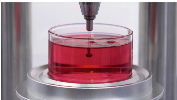
Bild 2: Bei der Methode des maximalen Blasendrucks werden über eine Kapillare Gasblasen in der zu untersuchenden Flüssigkeit erzeugt.
