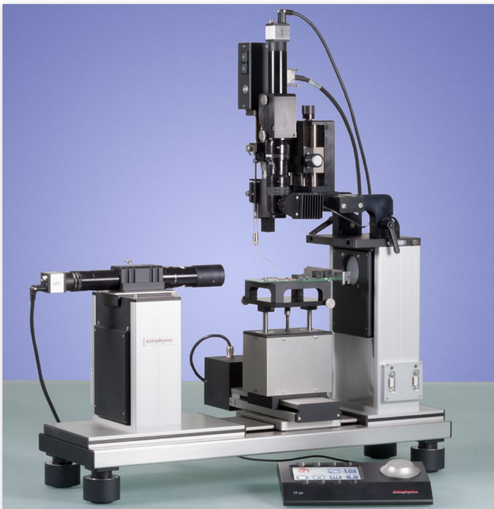
Topview Video System mit kollimierter koaxialer Beleuchtung TVS-C auf einem OCA 100
