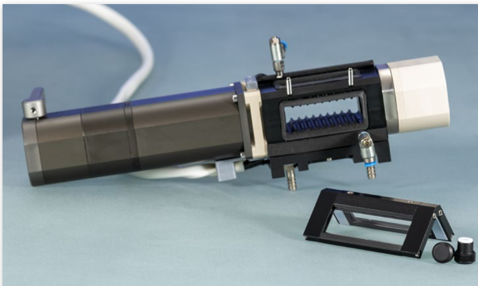
Messzelle mit entfernbaren Sichtfenstern für eine einfache Reinigung
