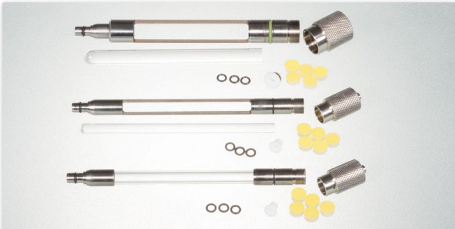
Halter für Einweg Glas Kapillare sowie Schnellwechselkapillare
