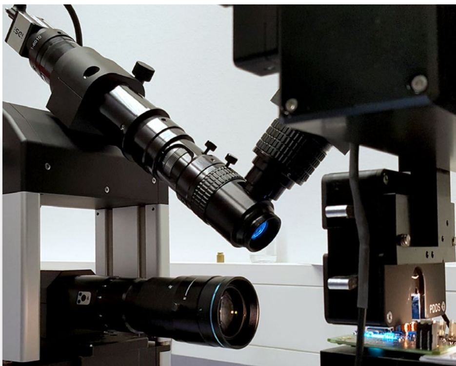
Abb. 2: OCA 200 mit zusätzlicher Optik für Aufsicht im 45°-Winkel und Pikoliter-Dosiersystem PDDS
