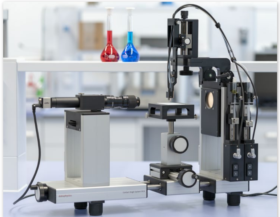
Abb. 1: DataPhysics Instruments OCA 25 mit Double Liquid Jet System DLJ
