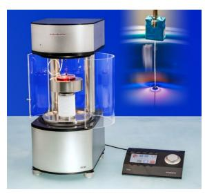
Bild 2: Mit dem Tensiometer DCAT 25SF sind dynamische Kontaktwinkelmessungen an Einzelfasern möglich. Copyright: DataPhysics Instruments
