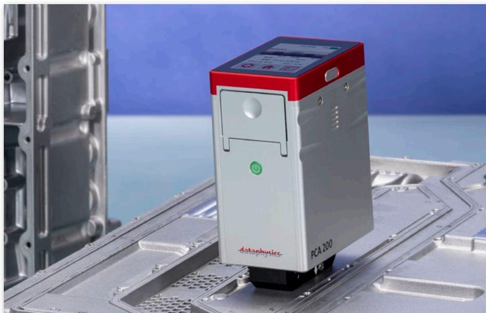
Das mobile Kontaktwinkelmessgerät PCA 200 ist ideal geeignet für die Qualitätskontrolle während des Fertigungsprozesses. Mit einem PCA 200 lässt sich die Oberflächenenergie schnell messen und so ein Beschichtungs- oder Reinigungsprozess innerhalb von Sekunden prüfen.
